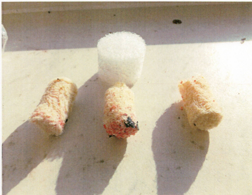
写真 上部新品スポンジと劣化したスポンジ
