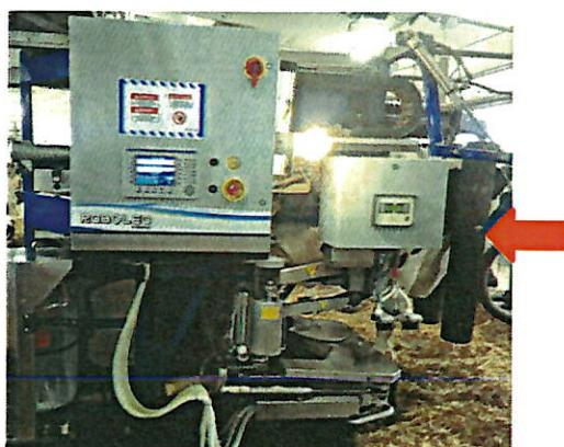
そして尿溝に橋がかかり、矢印のローラーが優しく牛の肩から挟み込み、牛を後方に移動させてロボットの中に収納します。
