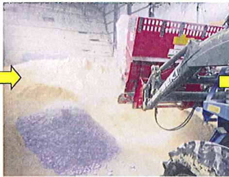
敷き料をベッドに排出したり、ミックスすることもできるバケット型の便利な機械
