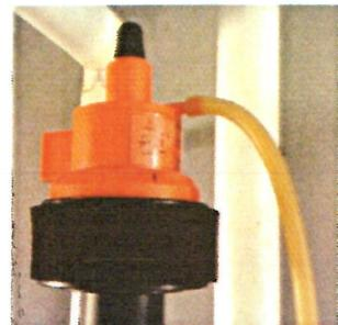
レギュレーター清掃後(周りのほこり、ニードルと言われる内部にある調圧針のサビ取りなど)、最初に測定したシステムオペレーティングバキュームS.O.V.と比べ清掃後の圧が上昇しました。理由として、圧が下がってきたら農家さんが自ら調圧して(圧を上げて)いたので、レギュレーターの掃除をしたことで本来の能力を発揮するようになったためと考えられます。
