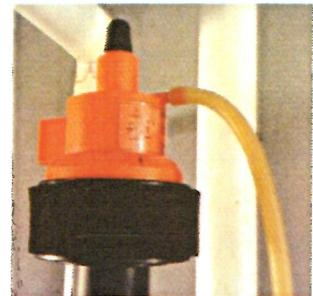
レギュレーター清掃後(周りのほこり、ニードルと言われる内部にある調圧針のサビ取りなど)、最初に測定したシステムオペレーティングバツキュームS.O.V.と比べ清掃後の圧が上昇しました。理由として、圧が下がってきたら農家さんが自ら調圧して(圧を上げて)いたので、レギュレーターの掃除をしたことで本来の能力を発揮するようになったためと考えられます。
