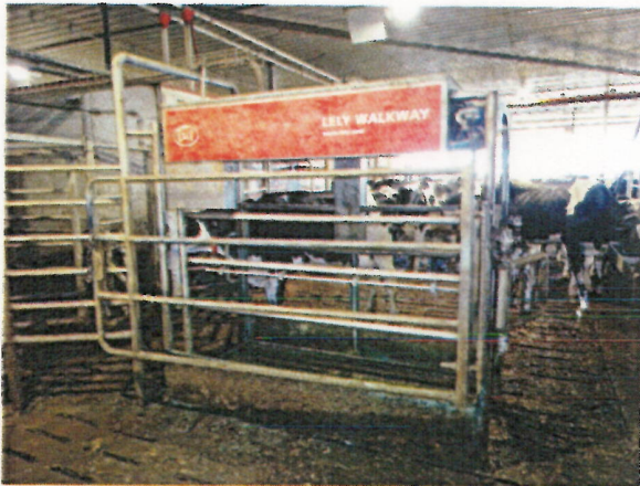
【フットバス型ロボット…Lely Walk Way】
